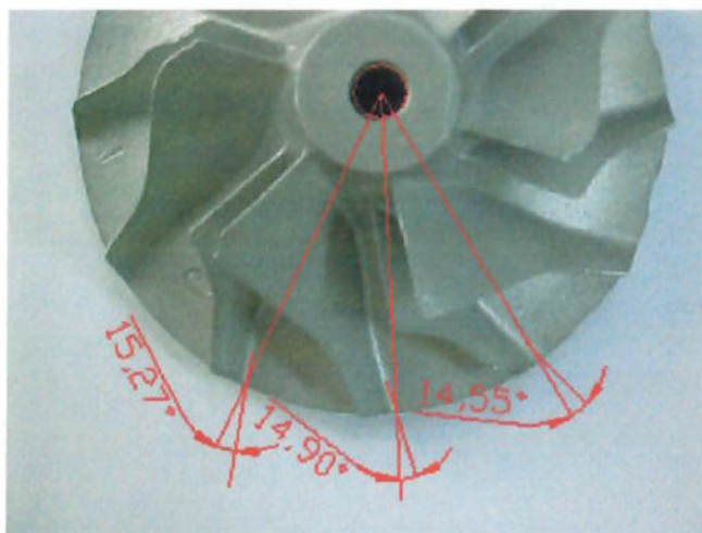
Figura 19 Medidas do ângulo \beta de saída
